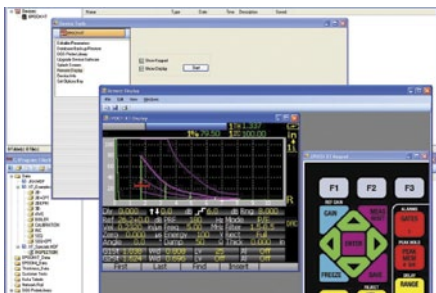
操作人员使用遥控显示功能可在PC机上察看实时EPOCH XT的视图。操作人员还可以通过屏幕上的键位或PC机的键盘控制所有仪器功能。
